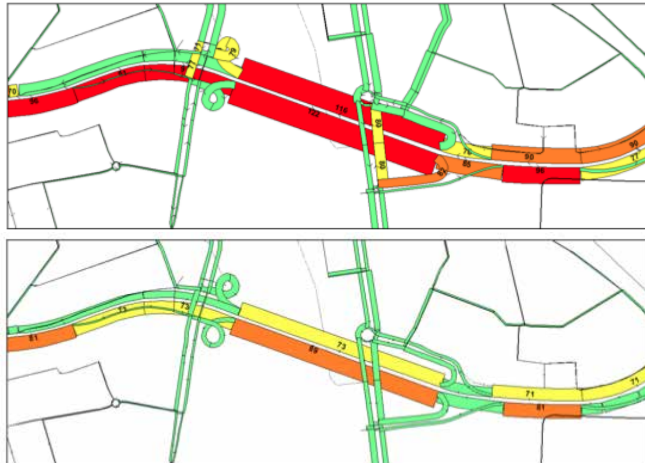
De figuur geeft de Intensiteit/Capaciteitsverhouding in de ochtendspits op de J.F. Kennedybrug voor de varianten 3 en 5. Duidelijk is zichtbaar dat de verkeerskundige gevolgen op het tracé over de J.F. Kennedybrug in variant 5 (met twee rijstroken per richting op de Noorderbrug) veel beter beheersbaar zijn dan in variant 3, waarbij er slechts één rijstrook per richting op de Noorderbrug tijdens de ombouw beschikbaar zou zijn.
